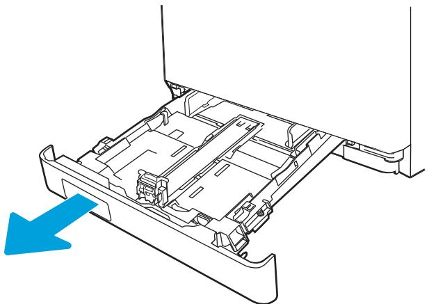
2. Отрегулируйте ограничитель ширины бумаги: нажмите на регулировочные защелки на направляющих и сдвиньте ограничители по формату используемой бумаги.
