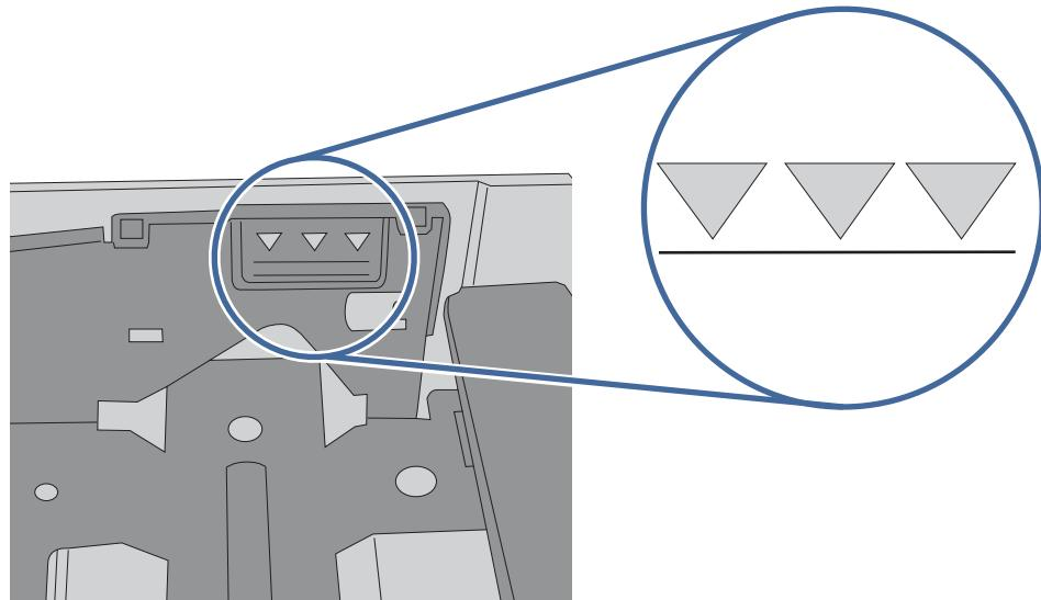
6. Проверьте, чтобы направляющие для бумаги были правильно отрегулированы по размеру носителя. Отрегулируйте направляющие, установив в соответствующие углубления лотка. Стрелка на направляющей лотка должна точно совпадать с отметкой на лотке.
