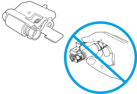
3. После очистки ролика установите узел держателя ролика в принтер так, как показано на рисунке, а затем сдвиньте его по направлению к правой стороне принтера.
