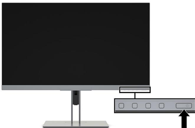
Lorsque le moniteur est mis sous tension pour la première fois, un message État du moniteur s'affiche pendant 5 secondes. Le message indique à quelle entrée correspond le signal actif actuel, l'état du réglage de la mise en source du commutateur automatique (activé ou désactivé ; le réglage par défaut est Activé), la résolution d'affichage pré-réglée actuelle et la résolution d'affichage pré-réglée recommandée.
